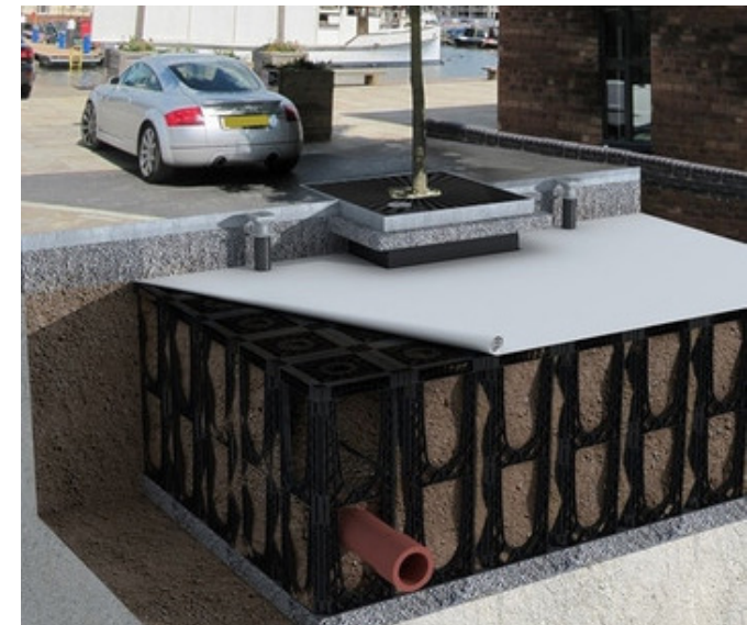
Wurzelkammersystem (Typ RootSpace, Fa. Greenleaf)
