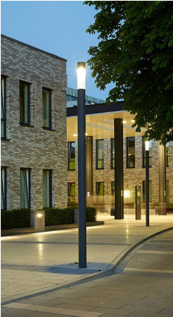
Lichtstele (LED-/Wi-Fi-Lichtbauelemente, Fa. Bega)
